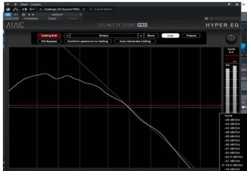
Gambar 15 Slope yang sesuai dengan sample ini, -19dB/octave
