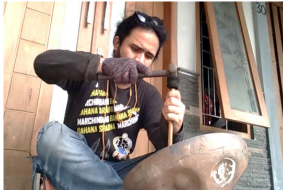
(Gambar 5. Proses pembuatan pengu satu dan dua. [Aldo Ahmad:2020])
