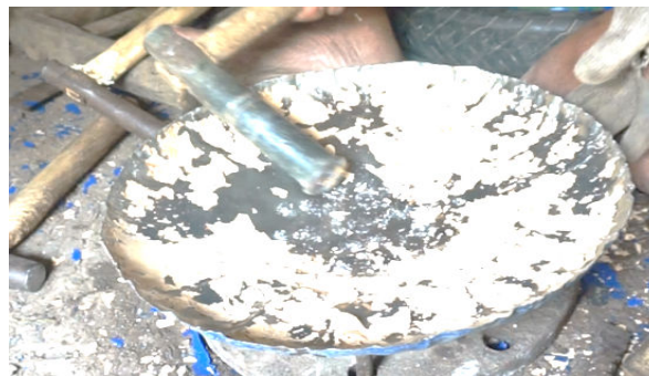
(Gambar 3. Proses Produksi Bagian Belakang Tasauf satu dan dua [Aldo Ahmad:2020])
