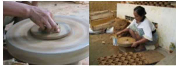
Gambar 3. Proses pembuatan gerabah di desa Pundong dengan teknik putar handwheel (Sumber: Foto Suharson, 10 Desember 2020)
