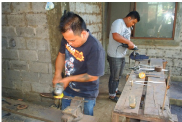
Gambar 3. Teknik Stock Removal di bengkel kerja T. Kardin (Sumber: Penulis, 2015)
