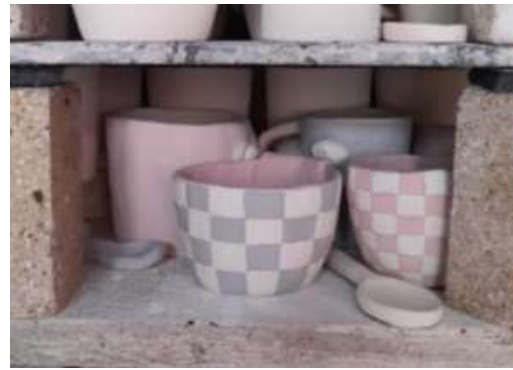
Gambar 21. Penyusunan Mug di dalam Alat Pembakar (Sumber: Dokumentasi Pribadi, 2021)
