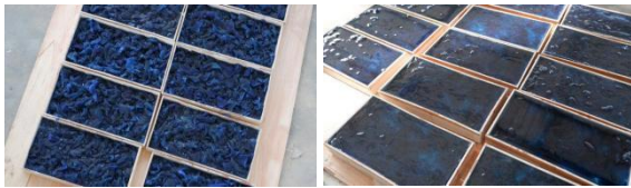
Gambar 7. Proses pengeringan dan penambahan resin pada cetakan (Sumber: Dokumentasi Pribadi, 2023)
