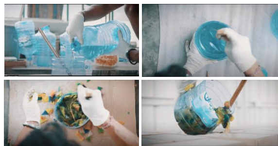
Gambar 6. Proses pembuatan adonan resin dan Busa Styrofoam & Busa PE Foam (Sumber: Dokumentasi Pribadi, 2023)
